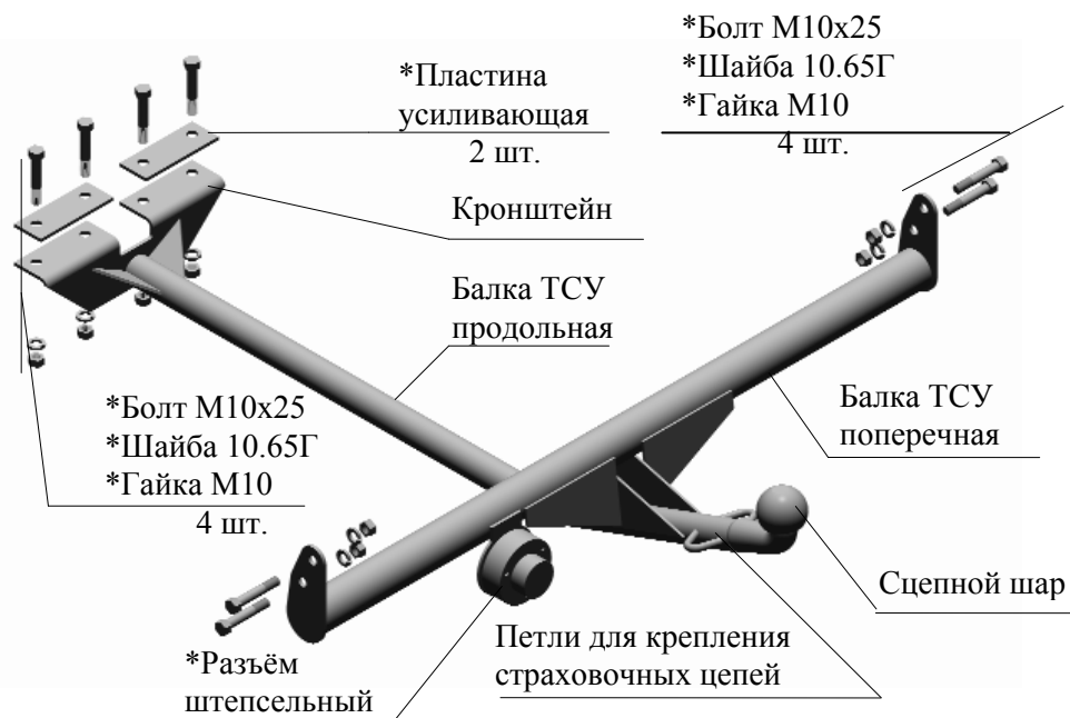
Рис.1 Тягово-сцепное устройство в сборе
